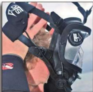
Figura 12: Abra as tiras inferiores e coloque a máscara sobre a cabeça
