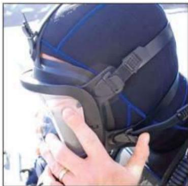
Figura 14: Para remover a máscara, segure pela parte inferior e posicione os polegares nas abas inferiores das fivelas
