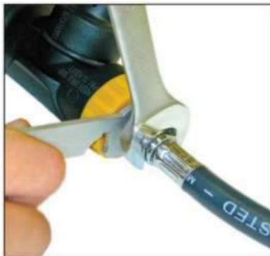
Figura 7: Encaixe da mangueira no regulador
