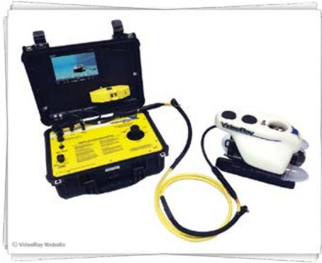
ROVs são utilizados para pesquisas e recuperação de vítimas de afogamento e objetos, inspecionar cascos, recuperação de evidências, tirar fotos e fazer vídeos etc, evitando a exposição de mergulhadores em ambientes perigosos, como águas profundas, fortes correntes, ambientes confinados, água contaminada, explosivos, inspeção nuclear etc. O uso de ROV está se tornando uma resposta rápida e segura para as equipes de PSD, evitando a exposição do mergulhador.
