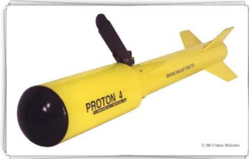
Funciona bem em terra, água doce ou salgada. Projetado para localizar e rastrear tubulações de ferro ou aço e cabos blindados, irá detectar todos os alvos ferrosos, enterrados sob qualquer tipo de material, incluindo concreto, sem perda de faixa de detecção.
