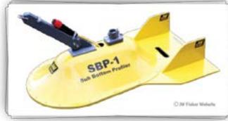
Usado para identificar e caracterizar camadas de sedimento ou rocha sob o fundo. O sub bottom profiler é semelhante a um ecobatímetro simples. Um transdutor emite um pulso de som verticalmente para baixo em direção ao fundo, e um receptor registra o retorno do pulso, uma vez que este foi refletido no fundo do mar, rio etc..
