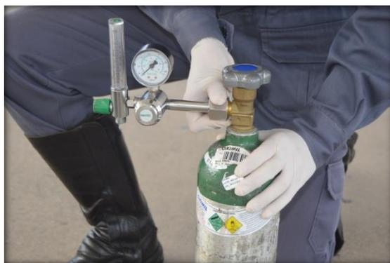
**Figura 9-1** - Cilindro, válvula redutora de pressão, manômetro e fluxômetro.
