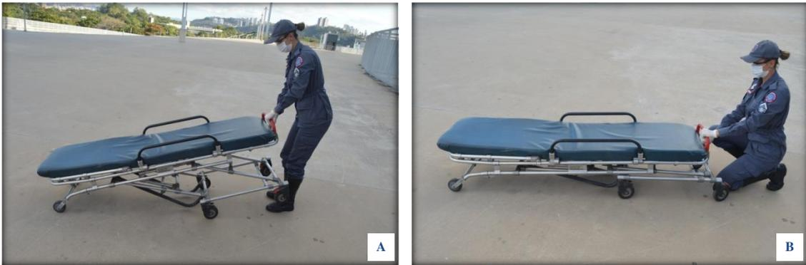
**Figura 55-10** – A. Inclinação final da maca. B. Nivelamento da maca com o solo.
