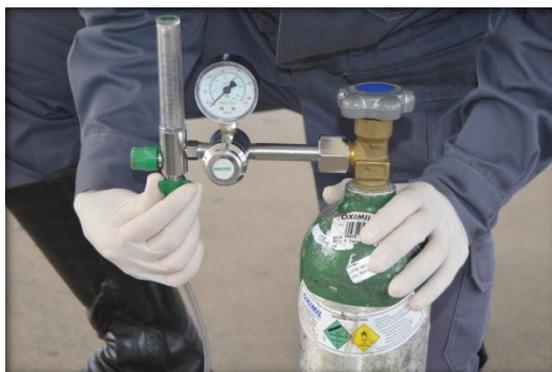
**Figura 9-3** - Conexão do conduíte no fluxômetro.
