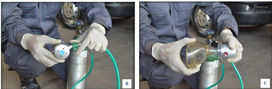
**Figura 9-25** - A. Acoplado mangueira ao manômetro. B. Encaixe da válvula à mangueira. C. Conexão da máscara à válvula.
