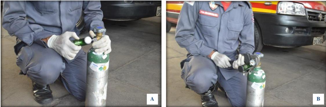
**Figura 9-24** - A. Manômetro da MTV 100. B. Encaixe com chave de boca ou inglesa.
