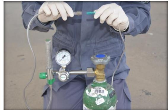
**Figura 9-6** - Conexão do cateter ao conduíte.
